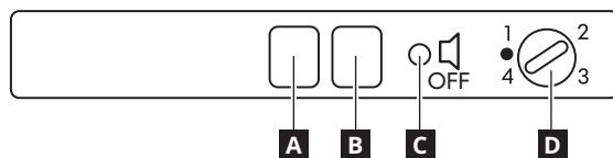
**A** SARKANS LED INDIKATORS: norāda, ka temperatūra saldētavā ir par augstu (sk. "Kā rīkoties, ja")
